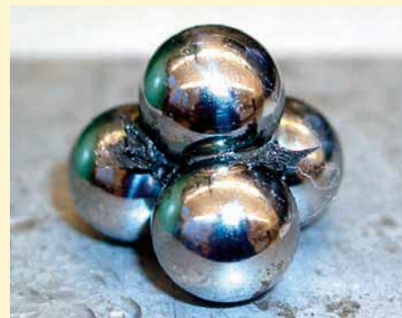
Zadření kuliček při provedení tzv. čtyřkuličkového testu
