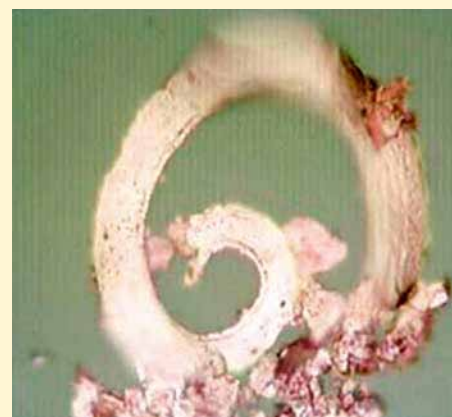
Obr. 3 Příklady částic zachycených ferografií (únavové a abrazivní částice)
