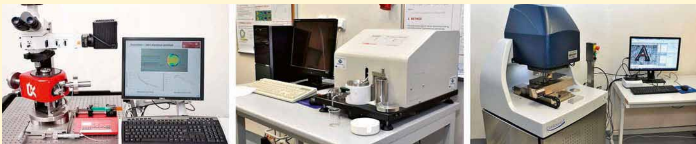
Obr. 1 Použitá experimentální zařízení: Optický tribometr, Mini Traction Machine a Optický profilometr
