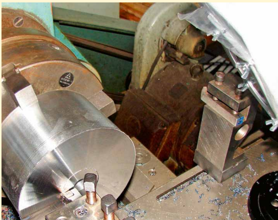
Obr. 1 Uspořádání zkoušky: 1 – dynamometr Kistler 9575B s řezným nástrojem, 2 – termokamera Flir 2000
