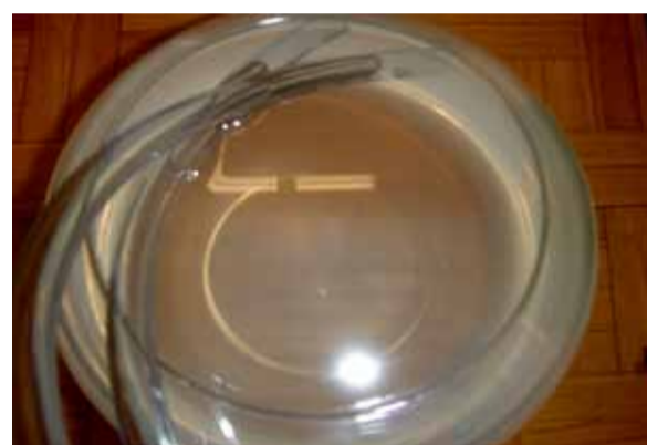
Zkušební kapalina Izopar H před čištěním
