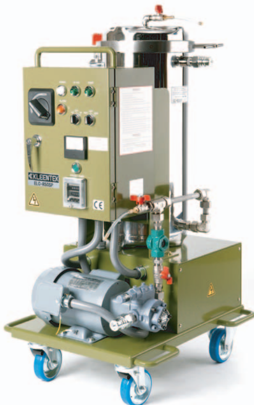
Obr. 5. Zařízení pro elektrostatické čištění oleje
